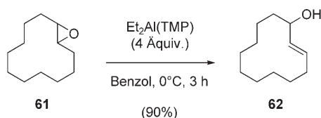
Schema 20. Deprotonierung von ( E )-Cyclododecenoxid ( 61 ) mit \text{Et}_2\text{Al}(\text{TMP}) .
